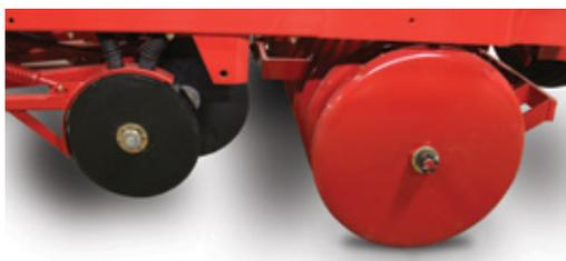
Les deux rangées de disques sont espacées de 15.24 cm et les disques ouvreurs d'une même rangée sont décalés d'avant en arrière de 15.24 cm pour assurer un suivi constant du sol et un meilleur nivellement.
